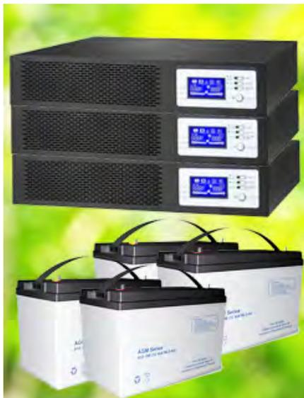
Минимально возможная ёмкость аккумуляторных батарей для данного комплекта инверторов 100 А\ч, работает с напряжением АКБ 48 Вольт. То есть требуется хотя бы 4 шт. аккумулятора.
