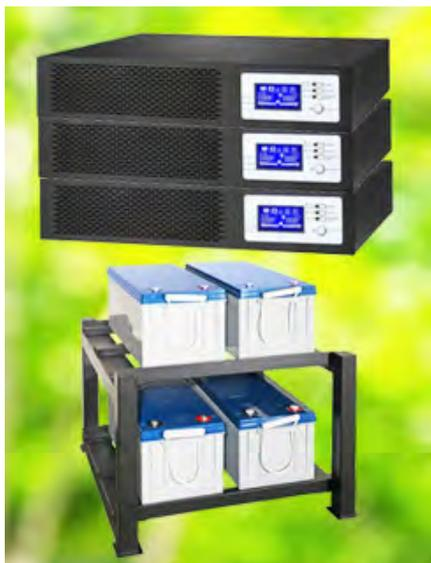
Минимально возможная ёмкость аккумуляторных батарей для данного комплекта инверторов 100 А\ч, работает с напряжением АКБ 48 Вольт. То есть требуется хотя бы 4 шт. аккумулятора на 12 Вольт, соединённых последовательно.
