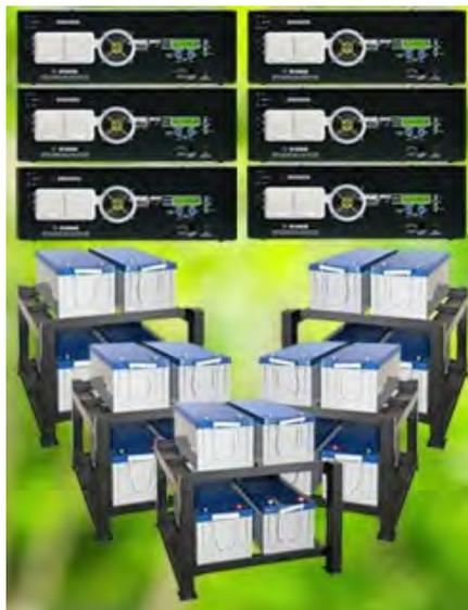
Решение построено на базе 12-и подключаемых параллельно - последовательно в сеть инверторов МАП-DOMINATOR 20 кВт 48 Вольт и 60 штук аккумуляторных батарей по 200А. соединённых параллельно \последовательно в сборку на 48 вольт.
